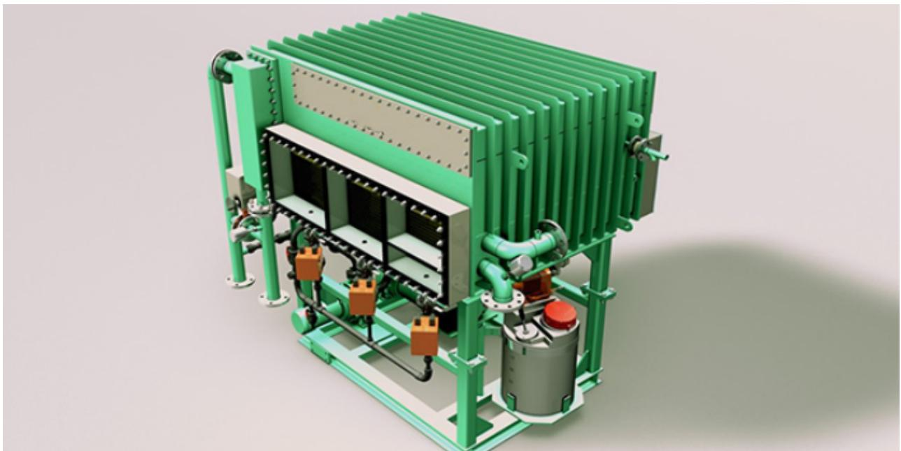
蒸发器不连续的原因：预热的影响。降膜式蒸发器要求必须是等于或高于沸点温度进料，进料温度低就更加难以连续进料、连续出料，单效自身的特点决定了其预热级数也要比多效蒸发器的预热级数要少。外循环蒸发器很少有预热，适合浓度较高、较粘稠的物料，其加热温度一般要比降膜式要高，传热温差大，其换热面积远远小于降膜式蒸发器的换热面积，也不能连续进料、连续出料。蒸发器能不能连续进料、连续出料是由物料特性决定的，是由蒸发器本身的特点决定的，是由蒸发器本身的特点决定的。
