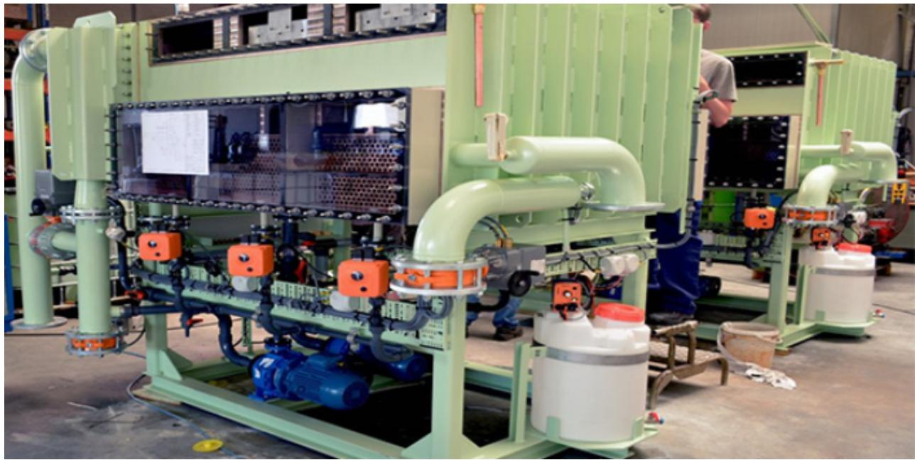
蒸发器具有哪些优点呢? 1、蒸发器处理过的废水出水水质好。蒸发器对各项污染物都具有极高的去除率, 出水水质好, 目前的主要运用为多种蒸发工艺, 完全可以满足各类回用或排放标准。2、蒸发器运行灵活, 可多工艺组合。蒸发器系统作为一套蒸发分离设备, 操作十分灵活, 可以连续运行, 也可间歇运行, 还可以调整系统的串并联方式, 来适应水质水量的要求。3、蒸发器建设周期短, 调试, 启动迅速。蒸发工艺的关键组件均在工厂组装完毕, 附以配套的厂房、水池建设, 规模很小, 建设速度快。设备运抵现场后只需两周左右的时间安装调试工作就可完成。4、自动化程度高, 操作运行简单。蒸发器工艺系统为全自动式, 整个系统设有完善的监测、控制系统PLC可以根据传感器参数自动调节, 适时发出报警信号, 对系统形成保护, 操作人员只需根据操作手
